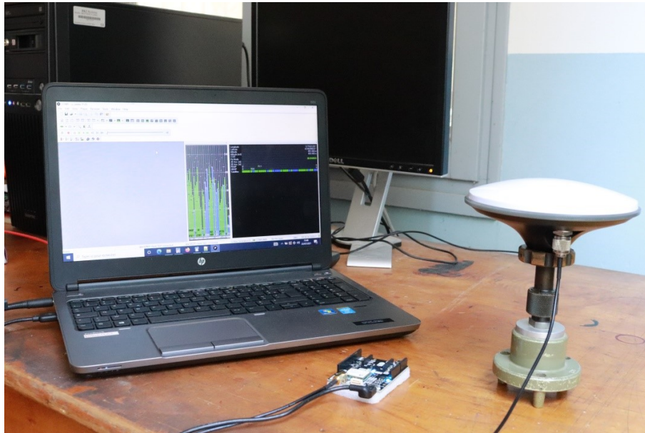
FIGURE 2 – Photographie du branchement pour le test du fonctionnement de la puce
